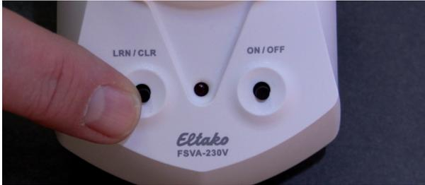
Drücken Sie anschließend den rechten Taster „ON/OFF“ 2 mal (Doppelklick), die LED wird 2 mal kurz zur Bestätigung blinken und dann wieder dauerhaft leuchten.
