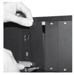
ACHTUNG: Das Öffnen des Gehäuses darf nur durch eine Elektro-Fachkraft erfolgen. Sie benötigen dafür einen Kreuzschlitz-Schraubendreher Gr. 1.
