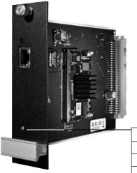
Das Modul IP-700 dient zur Erweiterung der IP-Sprachkanäle Ihres ES-Systems. Verbinden Sie die Netzwerkbuchse des Moduls mit Ihrem Netzwerk. Im Auslieferungszustand ist das Modul auf dynamische IP-Adress-Vergabe konfiguriert (DHCP-Client).
