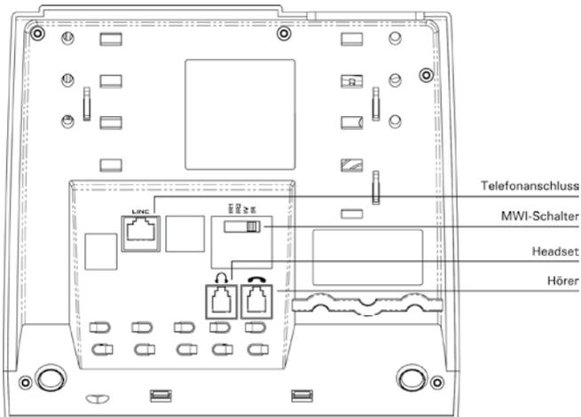
Der MWI-Schalter dient zur Umschaltung von unterschiedlichen Nachrichtenanzeigen (Message Waiting Indicator) einer TK-Anlage.
